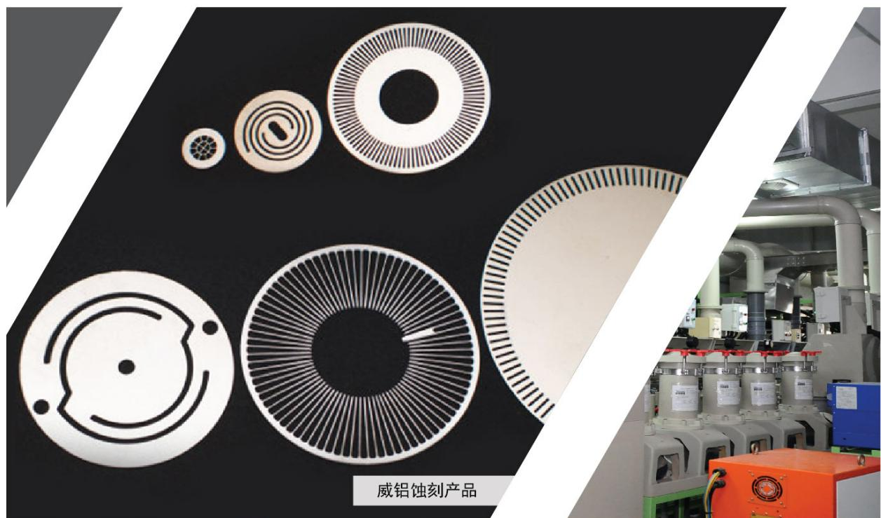
威铝已建立全新蚀刻生产线，占地600m<sup>2</sup>。该线适用于以铝合金、铜或不锈钢等为底材的各种金属之表面图案制作，并可以配合遮蔽技术进行遮蔽喷砂、遮蔽拉丝、遮蔽阳极等。同时，生产线具有自动监控技术，可监控药水的浓度和温度并自动加药，确保生产稳定性。
