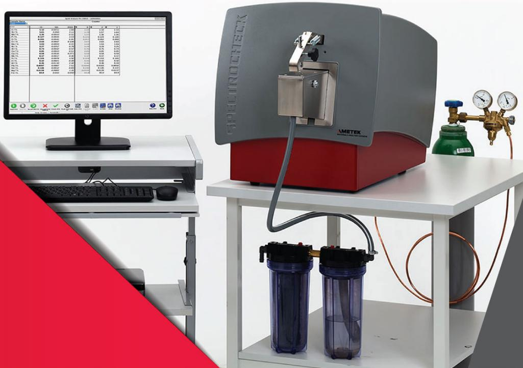
铝合金材料化学成份不合格会导致铝合金压铸件容易折断，因此，在熔铝前，原料的合金金属成份检验是至关重要的第一步。
