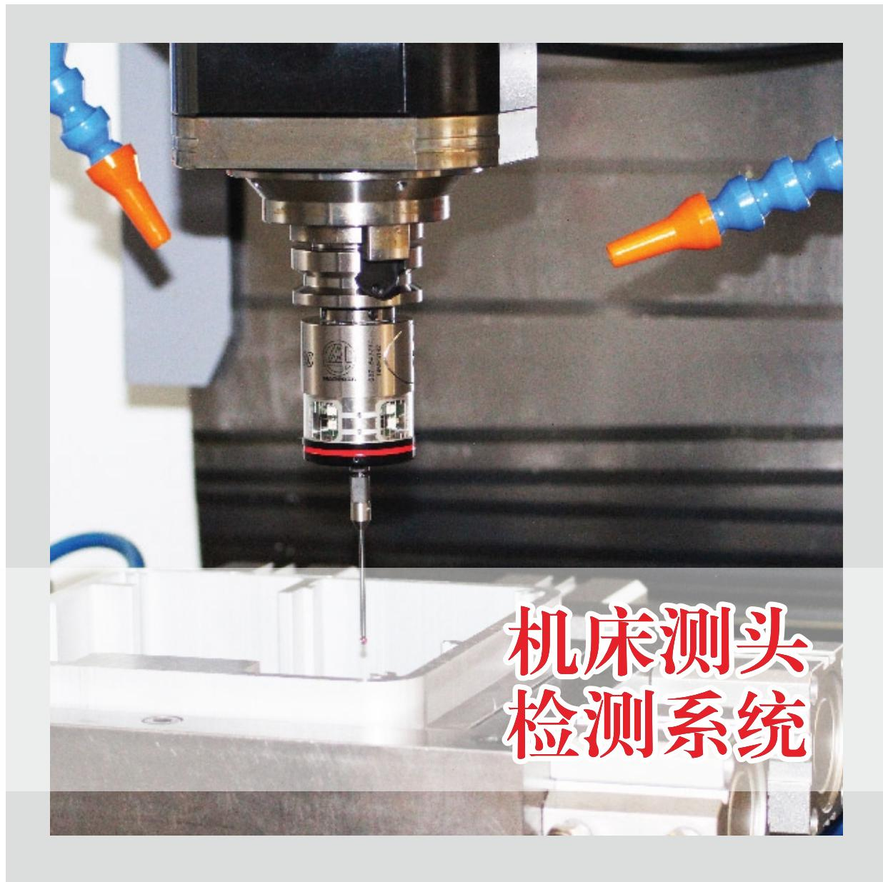
针对人工手动测量的低效率和不稳定性，机床测头系统成为生产企业提高加工精度的重要一环。它可以对工件特征进行测量并调整加工程序，从而进行适应性加工，确认成品工件的尺寸。
